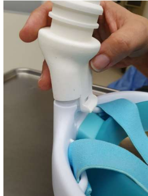
Foto 3. 3D-geprint koppelstuk tussen slang en masker.
