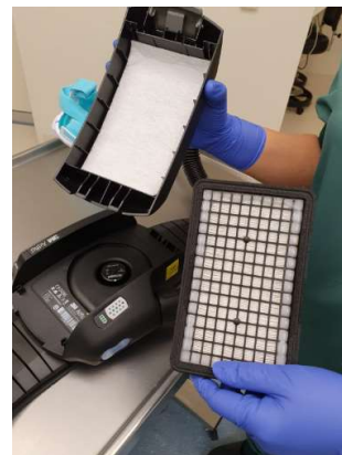
Foto 6. Filters in de luchtpomp.
